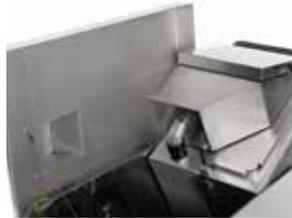
Die Verkleidungen und Abdeckungen der Maschine sind aus Edelstahl hergestellt; der Maschinenkorpus ist durch ein antistatisches Ableitband mit dem Fußboden verbunden
