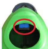
Vérifier que le filtre remplissage réservoir détergent est en bon état et propre
