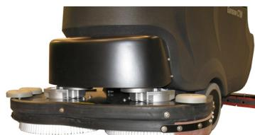
Vérifier que le suceur est propre et que les lames de séchage ne sont pas abîmées
