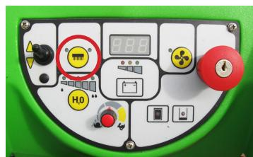
Pulse el botón aspirador para desactivar la aspiración, en caso que deseara realizar el prelavado de la superficie
