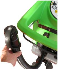
Den Schmutzwassertank reinigen
