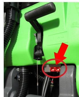
Selezionare la direzione di marcia spostando il selettori di direzione, ruotare il potenziometro per stabilire la velocità di lavoro.
