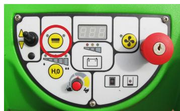
Wenn die Taste "H2O" für mindestens 2 Sekunden anhaltend gedrückt wird, erfolgt die Reinigungsmittelabgabe, bei wiederholtem Drücken der Taste ändert sich die abgegebene Menge
