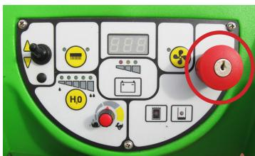
Bei Drücken der Bürstentaste schalten sich die Bürsten und die Absaugung ein
