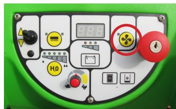
Seleccione la dirección de marcha moviendo el selector de dirección, gire el potenciómetro para establecer la velocidad de trabajo
