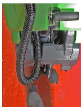
Baje el secador de suelos con la palanca
