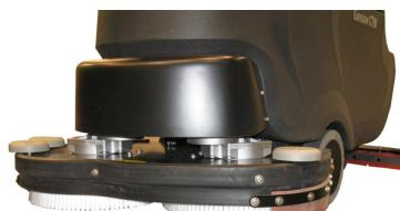
Controle que el secador de suelos esté limpio y que los labios no estén dañados
