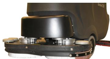
Verificare che il tergipavimento sia pulito e che le lame di asciugatura non siano danneggiate
