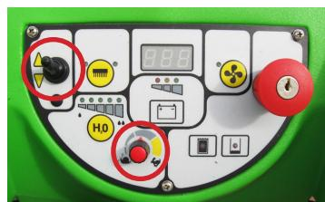
Accione la palanca de tracción
