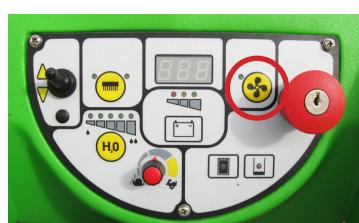
Sélectionner le sens de marche à l'aide du sélecteur de direction, tourner le potentiomètre pour régler la vitesse de travail
