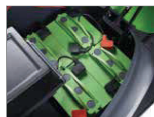
ALOJAMIENTO DE BATERÍAS
