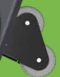
Il sistema autolivellante automatico mantiene costante la pressione sul pavimento, garantendo una pulizia uniforme su superfici irregolari.
