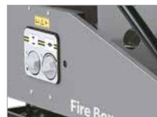
QUADRO ELETTRICO CON INTERRUTTORE D'ACCENSIONE E TERMOSTATO PER REGOLAZIONE DELLA TEMPERATURA.
