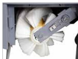
HERRAMIENTAS NO NECESARIAS PARA SUSTITUIR CEPILLO CENTRAL
