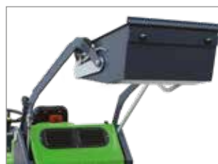
SISTEMA HIDRÁULICO DE DESCARGA DEL DEPÓSITO
