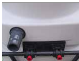
CONEXIÓN MANGUERA DRENAJE
