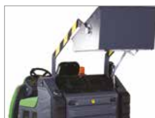
SISTEMA HIDRÁULICO DE DESCARGA DEL DEPÓSITO
