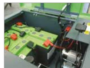
ALOJAMIENTO DE BATERÍAS (1280 E)
