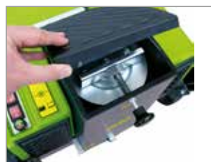
SACUDIDOR DE FILTRO
