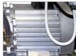
MOTOR ELÉCTRICO EXENTO DE MANTENIMIENTO, REFRIGERADO POR AIRE Y PROTEGIDO POR MAGNETOTÉRMICO
