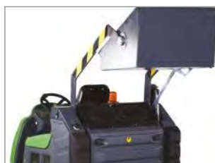
SISTEMA HIDRÁULICO DE DESCARGA DEL DEPÓSITO
