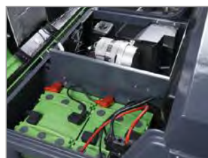
DUAL POWER CON MOTOR DIESEL
