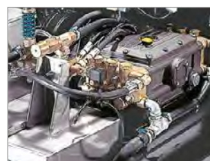
BOMBA DE LINEAL CON DOS CABEZALES DE LATÓN Y SEIS PISTONES DE CERÁMICA.
