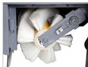
HERRAMIENTAS NO NECESARIAS PARA SUSTITUIR CEPILLO CENTRAL
