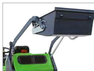
SISTEMA HIDRÁULICO DE DESCARGA DEL DEPÓSITO
