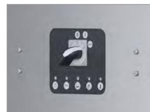
EN EL PANEL DE CONTROL: INTERRUPTOR ENCENDIDO/ APAGADO, LUZ CONEXIÓN DE RED, LUZ CONTROL DE LLAMA, ADVERTENCIA FALTA ANTI-CAL, LUZ DE ADVERTENCIA ASISTENCIA (150 HRS), LUZ MÁQUINA LISTA (TEMPERATURA ALCANZADA)
