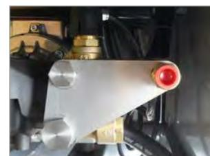
LA VÁLVULA DE BY-PASS INCORPORA 1 PLACA DE SOPORTE DE METAL PARA PROTEGERLA DEL ESTRÉS MECÁNICO
