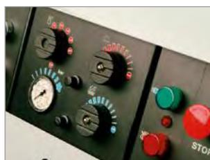
PANEL DE CONTROL CON APAGADO DE EMERGENCIA
