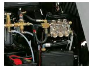
BOMBA DE ALTA PRESIÓN DE TRES PISTONES DE CERÁMICA Y CABEZAL DE LATÓN ESTAMPADO Y NIQUELADO.
