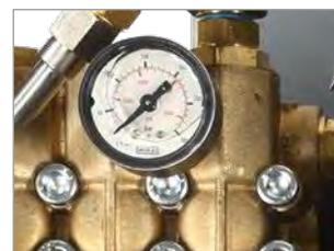
MANÓMETRO PROFESIONAL PARA EL CONTROL CONSTANTE DE LA PRESIÓN DE FUNCIONAMIENTO
