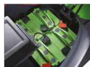
ALOJAMIENTO DE BATERÍAS (PARA 1050 E)
