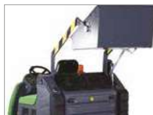
SISTEMA HIDRÁULICO DE DESCARGA DEL DEPÓSITO
