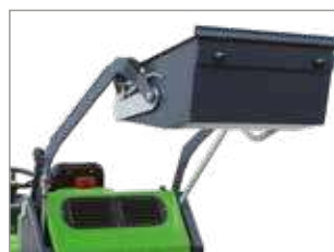
SISTEMA HIDRÁULICO DE DESCARGA DEL DEPÓSITO
