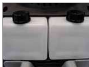
DOSIFICACIÓN REGULABLE DE 2 DIFERENTES DETERGENTES
