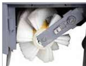
HERRAMIENTAS NO NECESARIAS PARA SUSTITUIR CEPILLO CENTRAL
