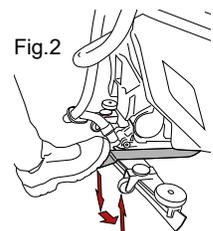
Desenganche automático del cepillo, versión con pedal de levantamiento del cabezal: levante el cabezal de la máquina empujando hacia abajo y hacia la izquierda el pedal de levantamiento del cabezal (Fig. 1), gire el selector hacia la posición "OFF", pulse una vez el botón "SET" y luego pulse el botón "-", la máquina ejecutará la secuencia de desenganche.
