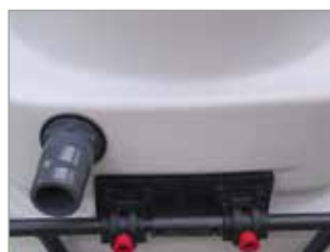
CONEXIÓN MANGUERA DRENAJE
