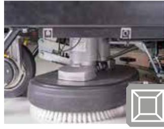
2 Bürsten sorgen für effiziente Reinigungskraft. Pendelnd aufgehängter Bürstenkopf zum Schutz von Anfahrtsschäden
