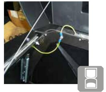
Alle beweglichen Maschinenteile sind mit Erdungskabel mit dem Maschinenkorpus verbunden
