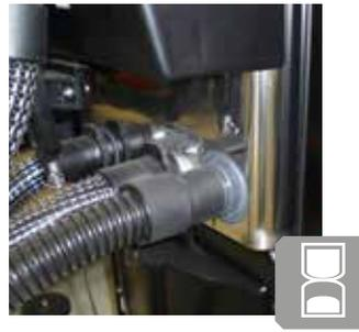
Die luftführenden Schläuche bestehen aus elektrisch leitfähigem Material
