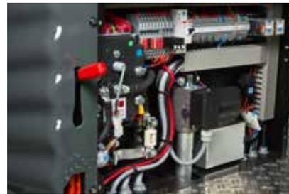
Die ACX-Steuerung ermöglicht die Vernetzung verschiedener Funktionen und steuert so optimal Betriebszustände wie z. B. den Sanftanlauf von Bürsten- und Saugmotoren, die GWS-Steuerung sowie programmierbare Parameter wie Bremsverhalten oder Geschwindigkeit
