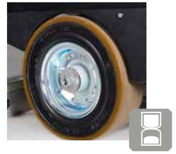
Hoher Fahrkomfort durch großdimensionierte Räder mit Super-Elastik-Kern und nicht radierende, rutschfeste PU-Bandagen
