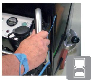
Der Lenkgriff ist aus Edelstahl gefertigt und mit einer Handgelenkerdung für den Maschinenbediener ausgestattet
