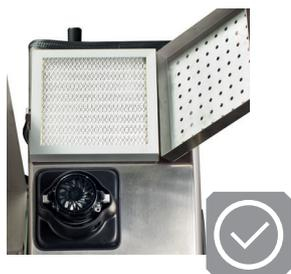
Der Abluftfilter Hepatex MDH3A (optional) entspricht der Filterklasse H 13 nach DIN EN 1822 mit einem maximalen Durchlassgrad von 0,05 % (siehe auch Datenblatt EURO-Schwebstofffilter)
