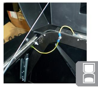
Alle beweglichen Maschinenteile sind mit Erdungskabel mit dem Maschinenkorpus verbunden
