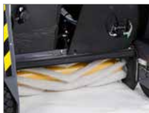
HAUPTBÜRSTE MIT V-FÖRMIGEN BORSTEN
