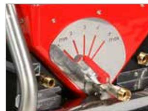
SISTEMA DI REGOLAZIONE INERTE REGOLABILE.
