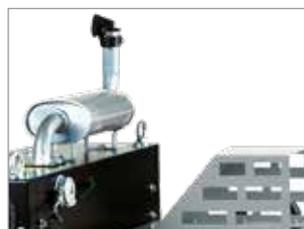
MOTORE DIESEL BICILINDRICO RUGGERINI RD 210 CON AVVIAMENTO ELETTRICO E DOPPIA MARMITTA CON SILENZIATORE.
