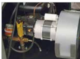
MOTORE BRUCIATORE MONOFASE ACCOPPIATO A VENTILATORE E POMPA GASOLIO
