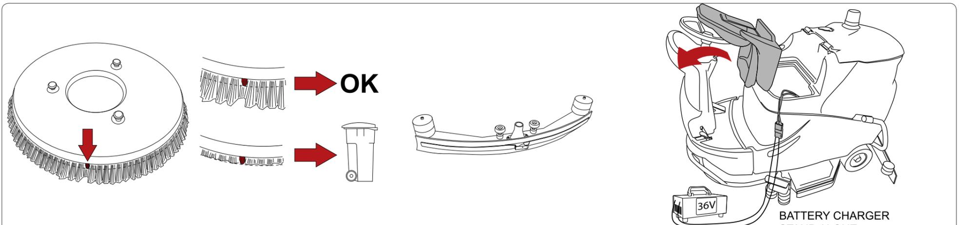
Verificare la pulizia della spazzola. Sostituire se necessario.
