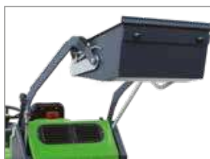
SISTEMA HIDRÁULICO DE DESCARGA DEL DEPÓSITO
