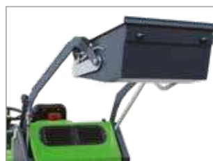
SISTEMA HIDRÁULICO DE DESCARGA DEL DEPÓSITO
