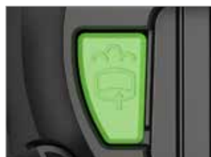
PULSE EL BOTÓN "CLEAN" PARA LIMPIAR EL FILTRO
