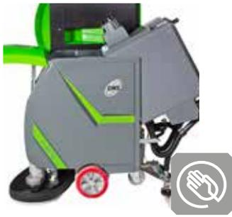
Der kippbare Tank ermöglicht den leichten und schnellen Zugang zu den wichtigsten Bauteilen der Maschine. Das Ausspülen und Reinigen des Tanks wird erheblich erleichtert
